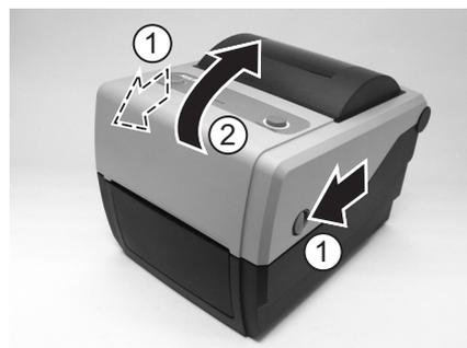
2. Tirare la **leva** al centro dell'**unità nastro** verso il basso per estrarre l'**unità nastro**. Poi rilasciare semplicemente l'**unità nastro**. Al centro c'è uno stopper che con il suo movimento impedirà al nastro di cadere giù.
