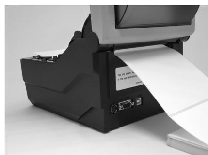
3. Tenendo premuta la **leva di scorrimento della guida**, regolare la larghezza del **supporto materiale di stampa** (1) in base al formato del materiale di stampa. Dopo aver estratto il materiale da stampa, fare passare il materiale attraverso le **guide del materiale da stampa** e posizionare il bordo anteriore del materiale sopra i **rulli di stampa**.
