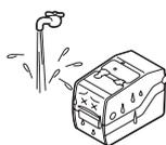
Non posizionare la stampante in un luogo esposto a spruzzi d'acqua o di olio. L'infiltrazione di acqua od olio all'interno della stampante può provocare incendio, scossa elettrica o disfunzioni.
